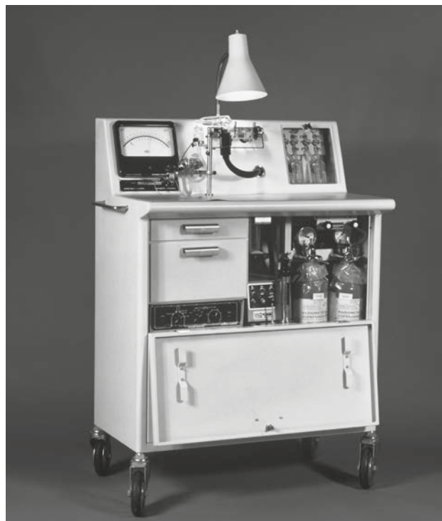
FIG. 14 - SISTEMA PER L'EQUILIBRIO ACIDO-BASE DEL SANGUE SECONDO IL METODO DI ASTRUP
